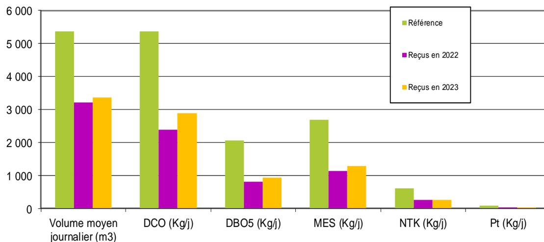
Pour 2023, le ratio DCO/DBO moyen est de 3,3 en comparaison à un ratio des stations nationales et une valeur nominale respectivement de 2,5 et 2,7. La biodégradabilité de l'effluent en entrée de la station est donc moins bonne que la valeur attendue.
