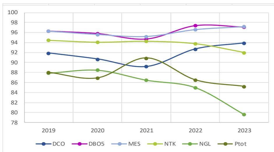
La dégradation du rendement en azote (NGL et NTK) est liée à la mise en place du nouveau traitement sur les PDN. La mise en place du média a impacté le fonctionnement de la station et les bactéries épuratrices n'ont pas encore colonisé l'ensemble du média
