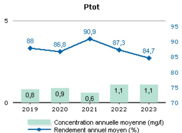
Les valeurs moyennes observées en sortie du système de traitement (concentrations et rendements) ne permettent pas de mesurer le respect de la prescription qui est à présent à calculer en considérant les débits à hauteur du débit de référence. L'évaluation du taux de respect fait l'objet de l'indicateur de conformité locale présenté dans la suite de la présente section.
